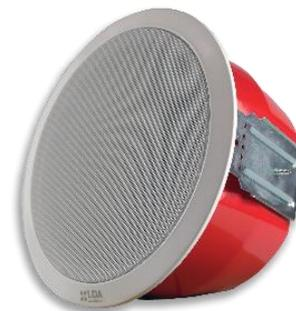
Serienmäßig wird dieser Deckeneinbaulautsprecher im Feuertopf geliefert. Er ist mit Keramikklammern und einer Trennsicherung ausgestattet, um zu vermeiden, dass eine Beschädigung eines einzelnen Lautsprechers zum Ausfall der angeschlossenen Lautsprecherleitung führen könnte. Diese Eigenschaften ermöglichen es, die Funktionalität und Verständlichkeit des Systems im Brandfall aufrechtzuerhalten.
