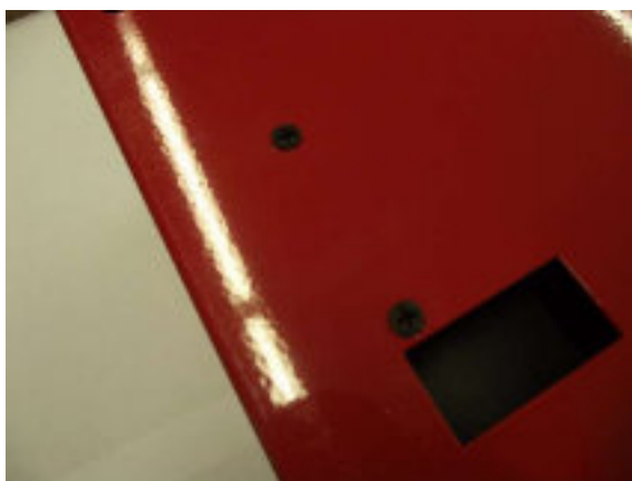
Abbildung 13: Verschraubung der VAP-1 im FIREPANEL links
